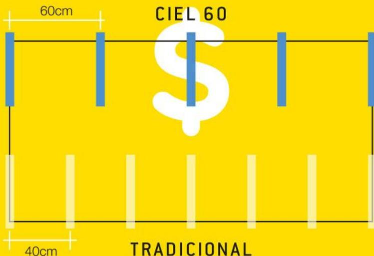
El Sistema **CIEL60** es el **único** capaz de instalarse con perfiles cada 60cm. Por eso necesitas **1 perfil menos** por placa con respecto a la instalación tradicional, cada 40cm.
