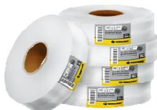
De celulosa, microperforada, de 50mm de ancho y pre marcada en el centro. Se utiliza para el tomado de juntas entre placas y para resolver ángulos internos formados por dos superficies construidas con placas SC Durlock®.
